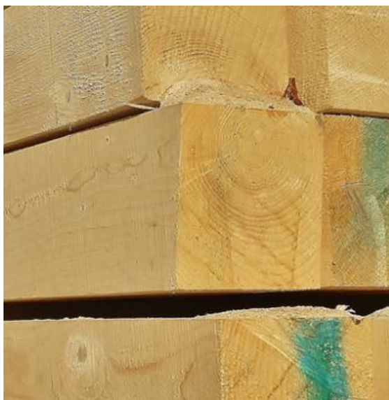
ТРЕЩИНЫ И ПРОРОСТЬ
