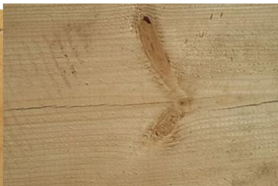
Трещина усушки
